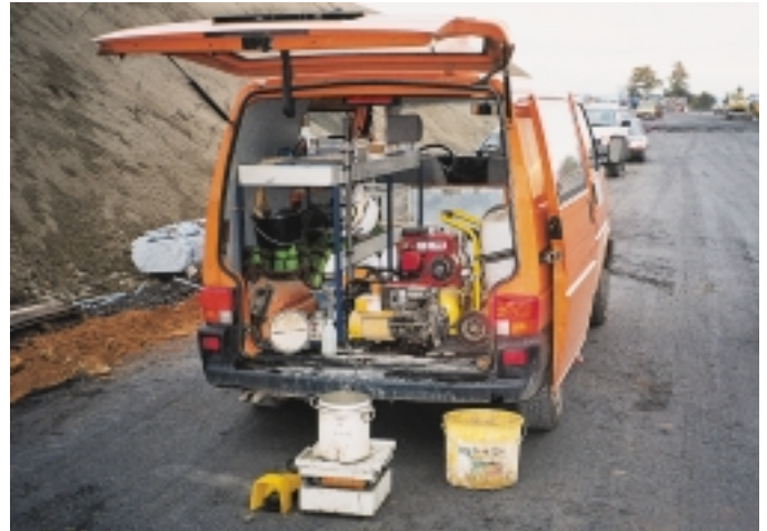
Bild 9: Die Kontrolle des Luftgehalts des Frischbetons gehört zu den wichtigsten Frischbetonprüfungen während des Betoneinbaus; Laborfahrzeug unter anderem zur Messung des Luftgehalts an der Einbaustelle
