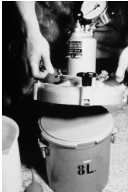
6: Die Bestimmung des Luftporengehalts des Frischbetons durch das Druckausgleichsverfahren gehört zu den wichtigsten Prüfungen während des Betoneinbaus
