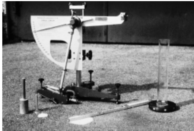
10: Zur Beurteilung der Textur einer Betonoberfläche möglichst frühzeitig nach der Herstellung eignen sich stationär arbeitende Meßmethoden wie das Pendelgerät, das Sandflächenverfahren und der Ausflußmesser
