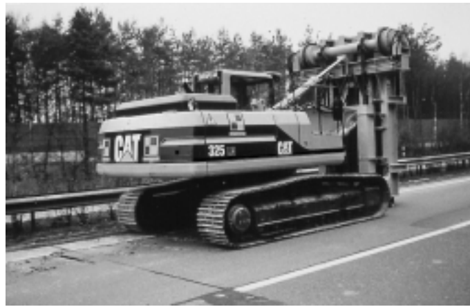
4: Heilit + Woerner-Spezialgerät zum leistungsfähigen Zertrümmern von alten Fahrbahndecken aus Beton
